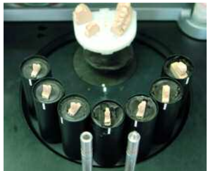
Abb. 5 Der etkon Scanner „es1“, bestückt mit den präparierten Stümpfen
